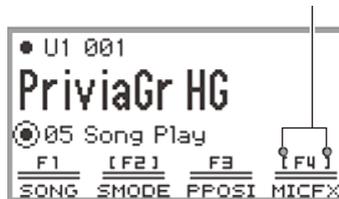
**3. Tippen Sie zum Deaktivieren des Mikrofoneffekts auf Taste F4 (MICFX). Die Klammern [ ] verschwinden.**
