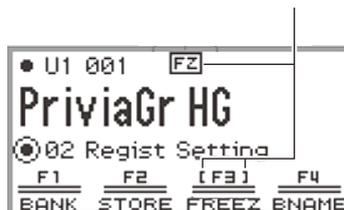
3. Tippen Sie zum Ausschalten der Freeze-Funktion auf Taste **F3 (FREEZ)**, damit **FZ** nicht mehr angezeigt wird.
